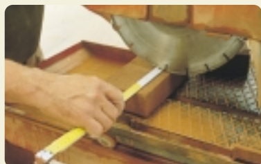
SEGA DA BANCO, O "CLIPPER", PER IL TAGLIO PRECISO DEI MATTONI
