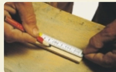
METRO DI LEGNO E MATITA A SEZIONE PIATTA
