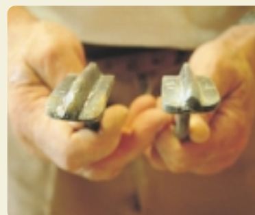
FERRI AD ALETTE PER GIUNTI INCAVATI STONDIATI
