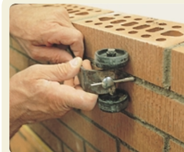
FERRO A CARRELLO CON PERNO REGOLABILE PER GIUNTI INCAVATI
